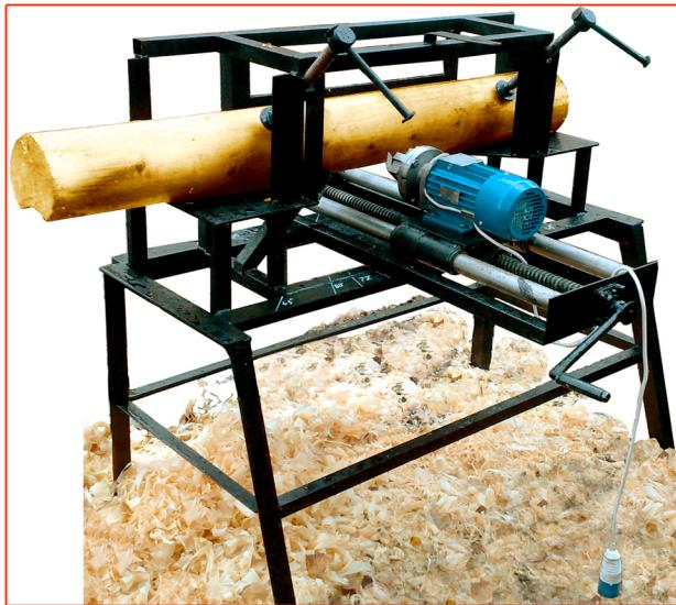
Переносной чашерезный станок решает проблемы качественной выборки угловых соединений при монтаже деревянного дома непосредственно на строительной площадке. Точность станочной нарезки в сочетании с мобильностью оборудования позволяют снизить затраты и увеличить производительность, избежать ошибок характерных для ручной выборки венцовых соединений, существенно повысить качество сборки деревянных конструкций, сократить сроки выполнения работ.
