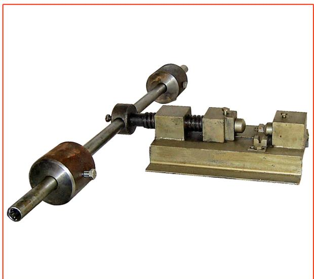
Комплект ручных оснасток для изготовления художественных изделий из металла методом холодного гнутья. Оборудование прекрасно подходит для изготовления ажурных решеток, ограждений, перил, входных групп, кованой мебели. Разнообразие возможных элементов позволяет воплотить в металле практически любую идею от самой простой, до самой изысканной. Возможность комбинации стандартных повторяющихся элементов с готовыми заготовками позволяет создавать поистине неповторимые композиции из металла.
